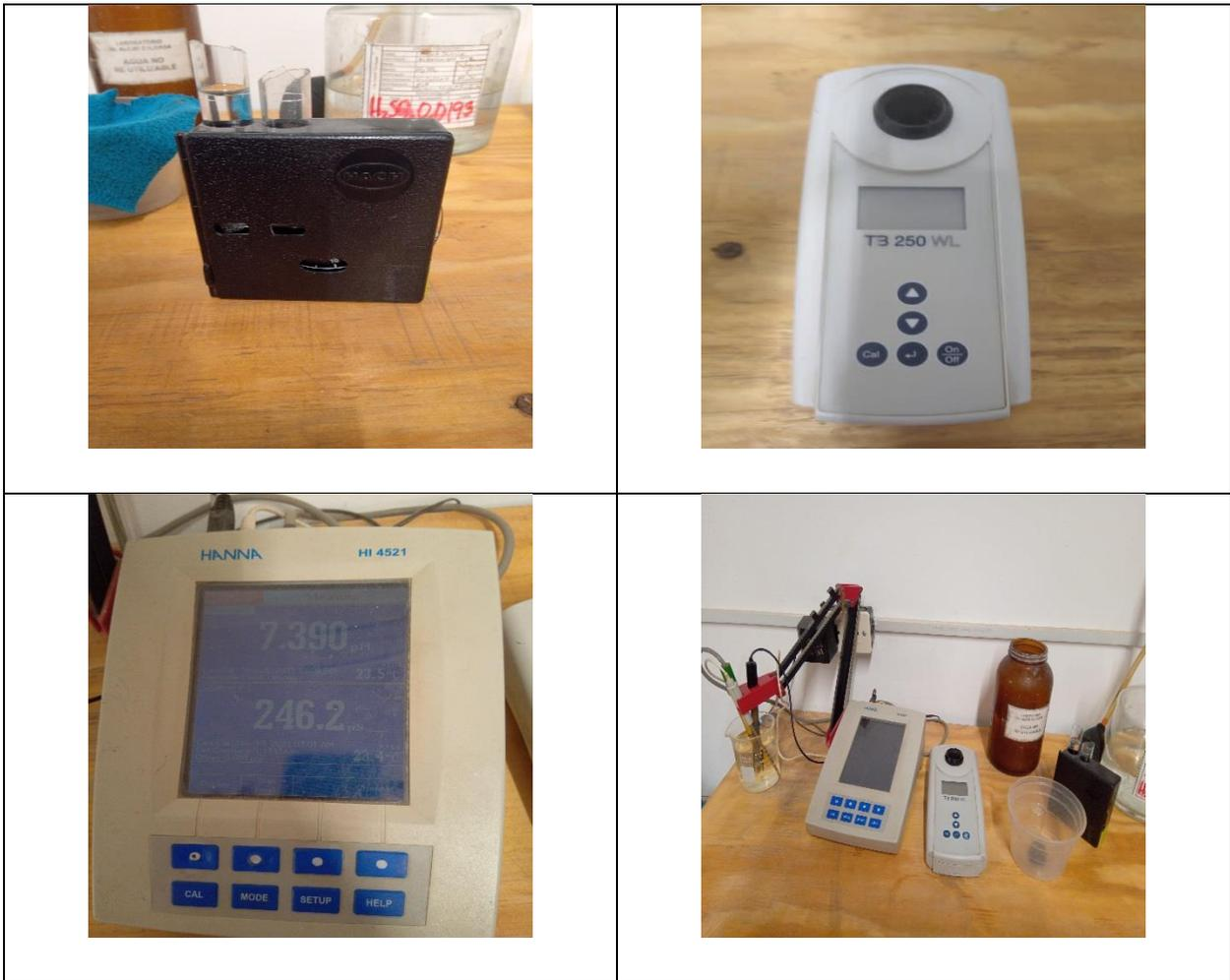
**Tabla de ilustraciones 9.** Equipos de medición de parámetros organolépticos, colorímetro, turbidímetro y peachímetro.
