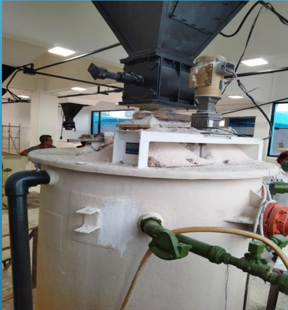
Entrada al tanque de mezclado de sulfato de aluminio sólido, regulado mediante tornillo sin fin horizontal.
