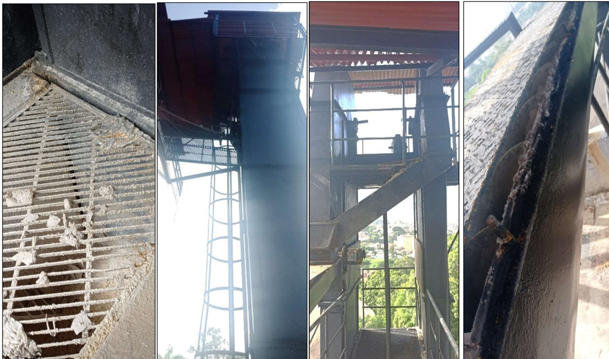
Fig. 8. Tanque de almacenamiento- Elevador de cangilones – dosificador y tornillo sin fin para sulfato
