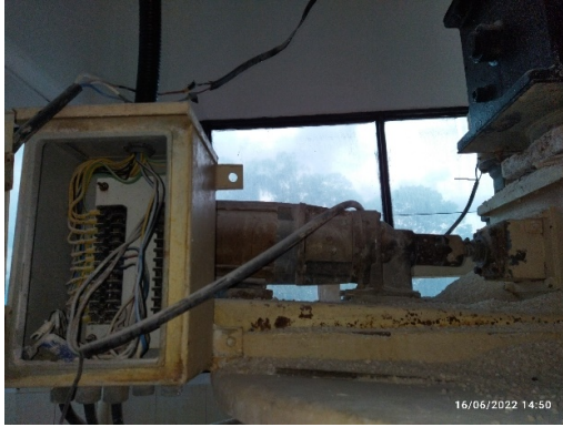
Panel de control del motor que mueve el tornillo sin X
