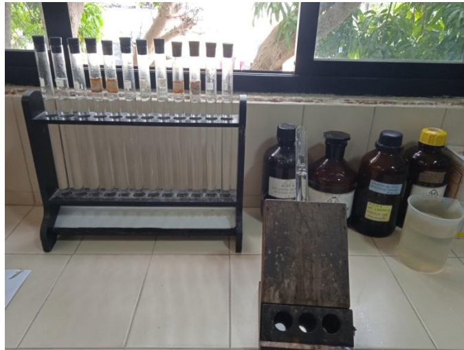
Tubos Nessler (patrones), tubo tomamuestra y visor comparador (Colorimetría)
