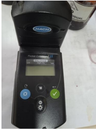
Medición de cloro digital y medición apreciativa
