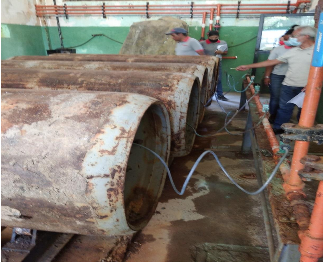
Balanza de 5 toneladas con sistema de Pesaje y rodillos para maniobrabilidad de cilindros
